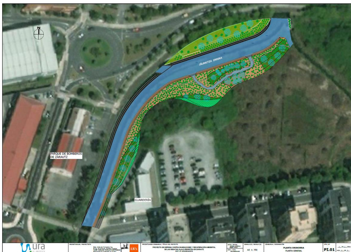
33. irudia: Iritako eremuan iñurritza erreken desbideratzerako proiektuaren oin plano. Iturria: Zarauzko udalerrian Olaa eta Iñurritza errekaen uholdeetatik babesteko eta ingurumena berreskuratzeko Proiektua. Ura – Ur Agentzia.
